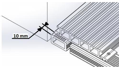
Při pokladce okrajových desek je potřeba (po celém obvodu terasy) ponechat vůli 10 mm. Tato vůle slouží pro vymezení délkové roztažnosti desek vlivem změn okolní teploty a vlhkosti.
