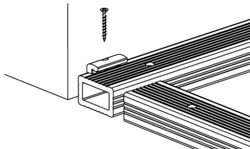
Do nich poté zapasujeme první řadu terasových desek. (To platí, začínáme-li pokládku od zdi, nebo jiné svislé překážky. V případě pokládky z otevřeného prostoru se pokládka začíná i ukončuje stejným způsobem – viz níže „montáž poslední desky“).
