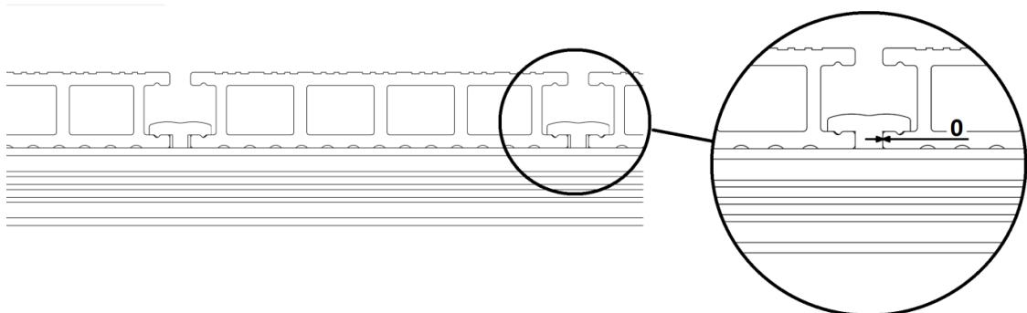
V případě potřeby podélného spojení terasových desek je nutné podložení obou spojovaných konců vlastním konstrukčním hranolem. **Rovněž je nutné upevnit každou desku samostatně, přičemž musíme ve spoji ponechat dilatační mezeru min. 6 mm!**
