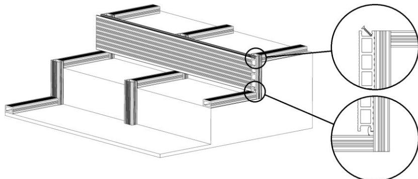
Pro překrytí spoje, na sebe kolmých, terasových desek slouží hliníková lišta. Ta se připevňuje shora pomocí vrutů. Aby vruty z lišty nevyčnívaly, je nutné otvory zahloubit dle potřeby šroubu. Rozteče mezi vruty by neměly přesáhnout 200 mm.
