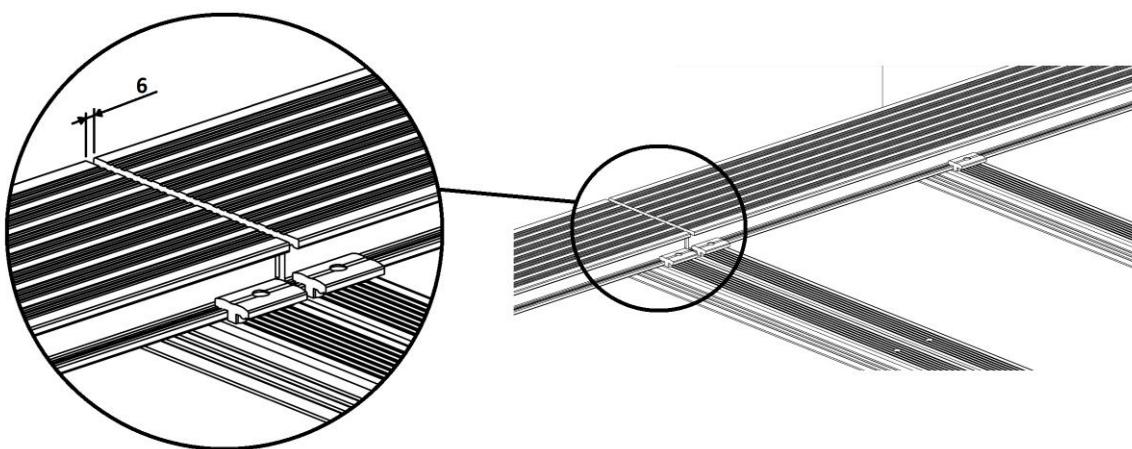
Montáž poslední desky se provádí bez použití klipu, a to přišroubováním desky pod úhlem přímo ke konstrukčnímu hranolu. Před samotným šroubováním je potřeba předvrátat otvor o průměru 3 mm. Stejným způsobem se začíná v případě pokládky z otevřeného prostoru.
